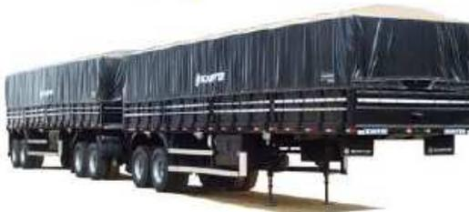
✓ Combinação de dois semi-reboques acoplados através do Dolly. Geralmente são semi-reboques mais longos .
