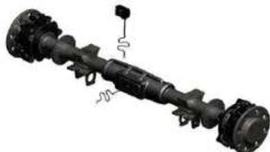
✓ Pode ser utilizado em caminhões ou rebocadores. Serve para aumentar a capacidade de carga do veículo. Alguns caminhoneiros colocam a "bolsa de ar comprimido" (acessório), que permite que a roda fique suspensa quando não utilizada, evitando seu desgaste.
