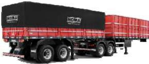
✓ Combinação de dois semi-reboques acoplados entre si, por meio de uma quinta roda na traseira do primeiro semi-reboque. Geralmente são semi-reboques curtos.
